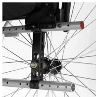
Hinterradaufnahme Der Schwerpunkt kann um 50 mm angepasst werden. Die Sitzhöhe lässt sich ganz leicht ohne Werkzeug einstellen.
